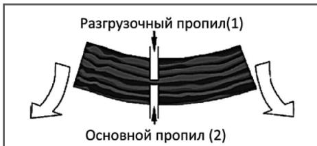
Рис. 16 Распиливание дерева, когда его нижняя часть находится под напряжением
