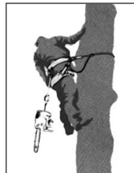
**Рис. 20 Крепление бензопилы к задней средней точке ремня**
