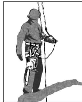
**Рис. 19 Пример крепления пилы к ремню оператора**
