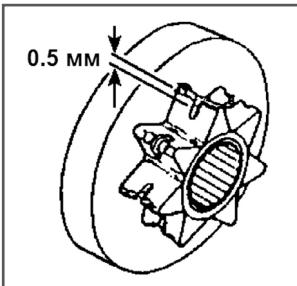
Рис. 34 Максимально допустимая глубина износа зубьев ведущей звездочки
