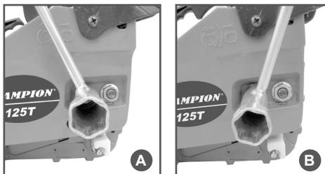
Рис. 4 Затяжка гайки крепления
